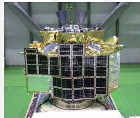
フライトモデルのシステム試験
