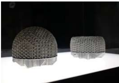
展示中の「衝撃吸収材」（左が使用前、右が試験後の潰れたもの）
