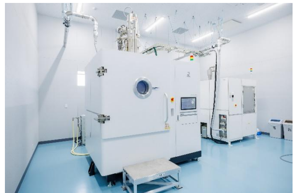
導入した日本電子株式会社製の EB-PBF 方式の金属 3D プリンター 「JAM-5200EBM」
